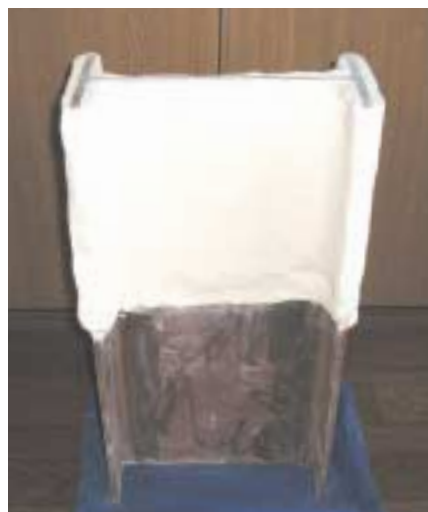
H型鋼に接着された超高温耐火断熱材
