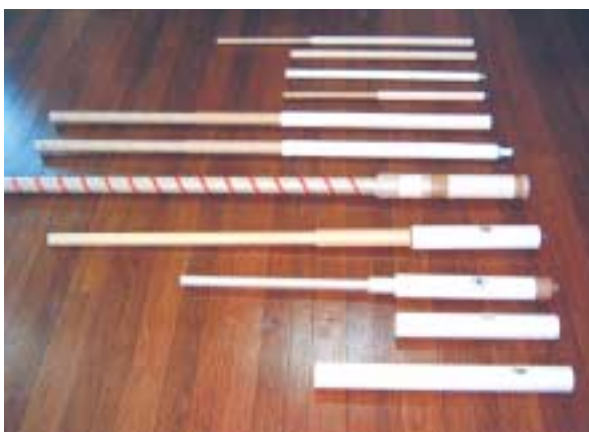
紙管と珪藻土を一体成型してつくった各種耐熱保護管
