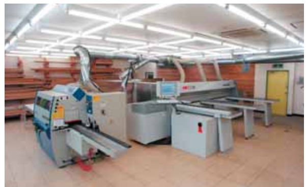
最新鋭のドイツ製モルダー（向かって左側）や無垢材加工機（右側）が設置してある「フーメックス2」
