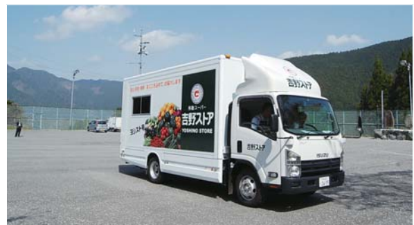
停車後、車体を拡幅でき、広い販売スペースを確保できる拡幅式移動店舗販売車の「ヨシスト号」
