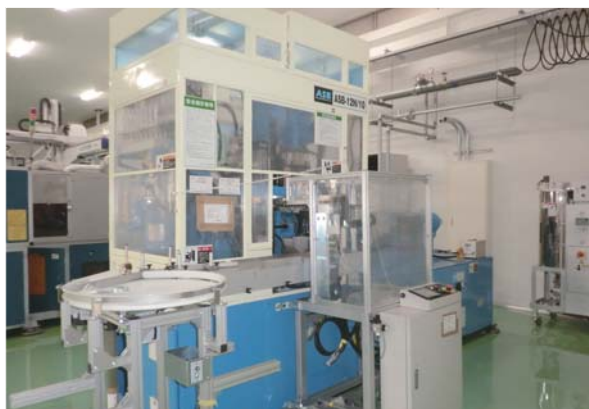
ブロー成型によるブローボトル（シャンプー用ボトル等）を製造する広陵工場に設置されたインプロ成型機
