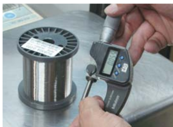
出荷前検査では、線径等の品質が厳しくチェックされる（左）
