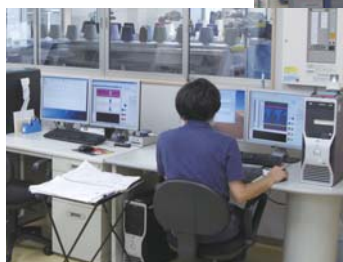
コンピュータにデザインを入力し、各編立機に生産指示を出す（左）
