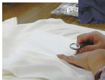
検品工程ではルーペを用い、万一の製品不良や糸くずを細かくチェック（左）
