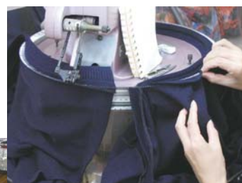
網目一つ一つを針にかけ、細かい作業への熟練を要するリンクング工程（右）
