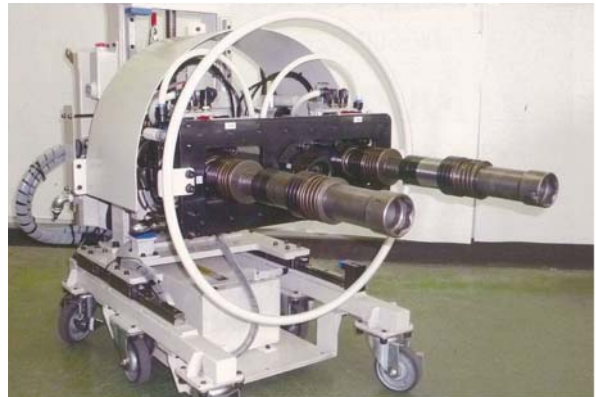
「関西ものづくり新撰 2015」に選定された大型トラック・バスの 2 輪ホイールナット締付システム
