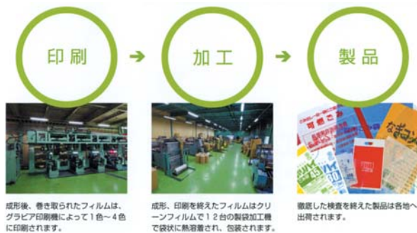
リサイクル製品の一般的な製造工程
