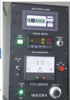
測定値をデータ処理する「指示計」(右)
