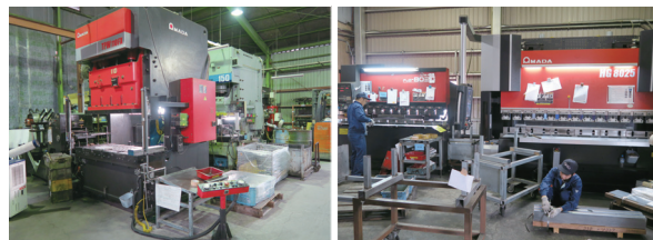
（左から）「ものづくり補助金」等を活用して導入された最新鋭のプレス機/同じくベンダー（曲げ加工）機
