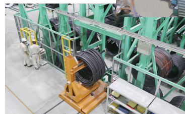
自動搬送ラインと連携した立体倉庫（左）
